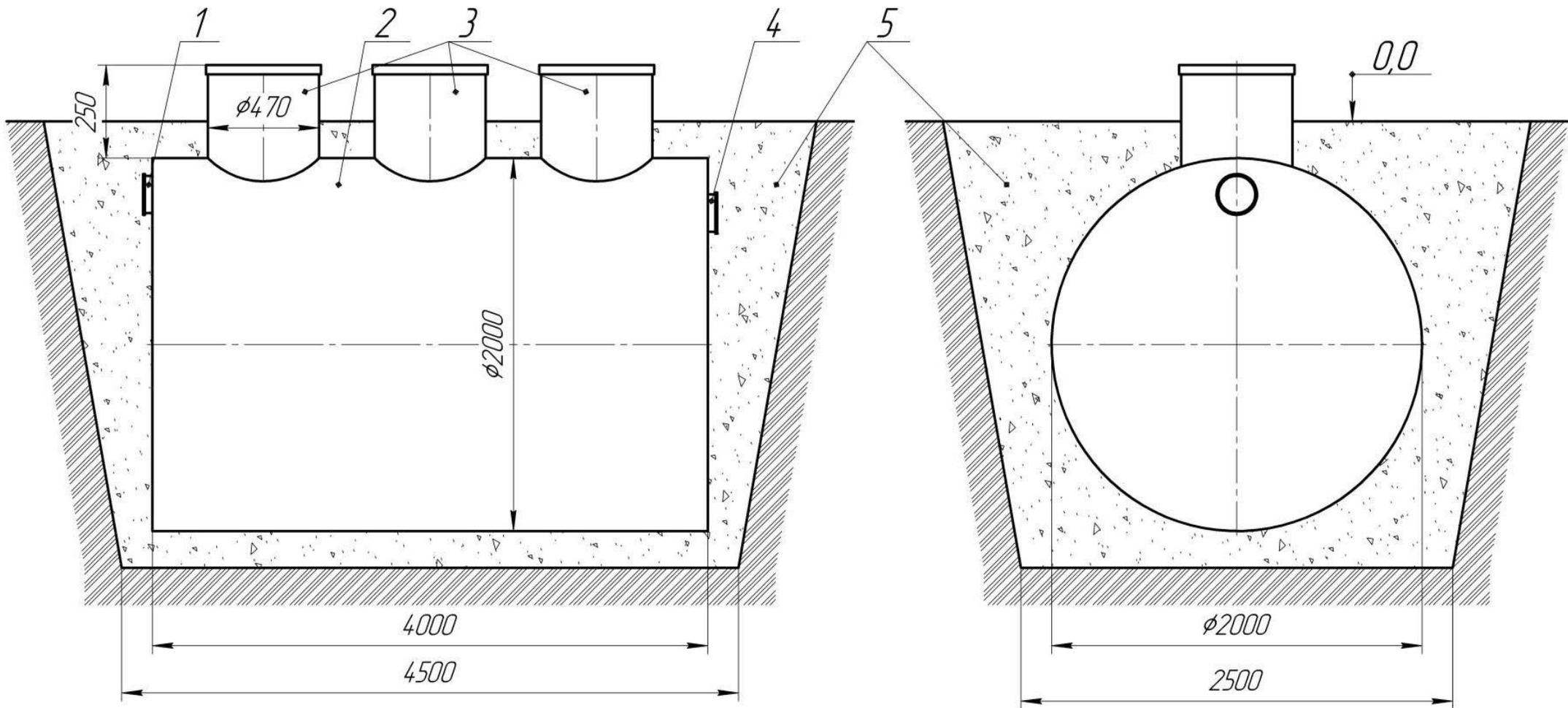
1 – Патрубок входной  $\phi 110$ ; 2 – Корпус жироуловителя; 3 – Горловины; 4 – Патрубок выходной  $\phi 110$ ; 5 – Песок крупнозернистый уплотненный
