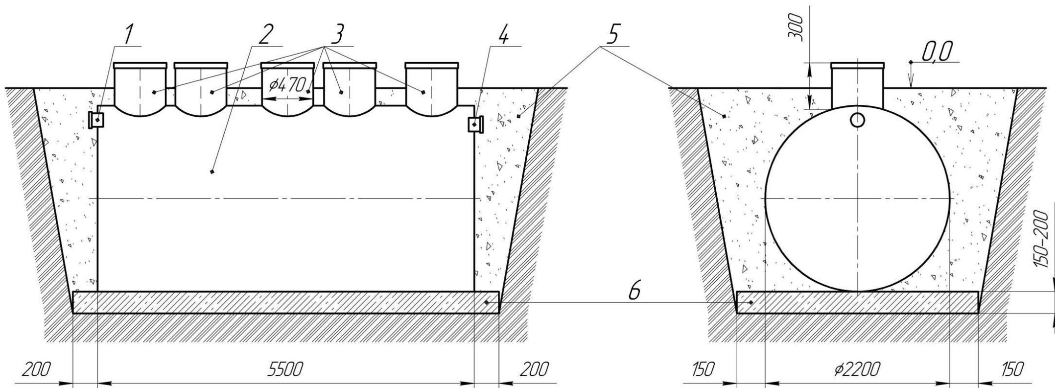
1 – Патрубок входной; 2 – Корпус ЛОС «Биосфера 50»; 3 – Горловины; 4 – Патрубок выходной; 5 – Песок уплотненный; 6 – железобетонное основание
