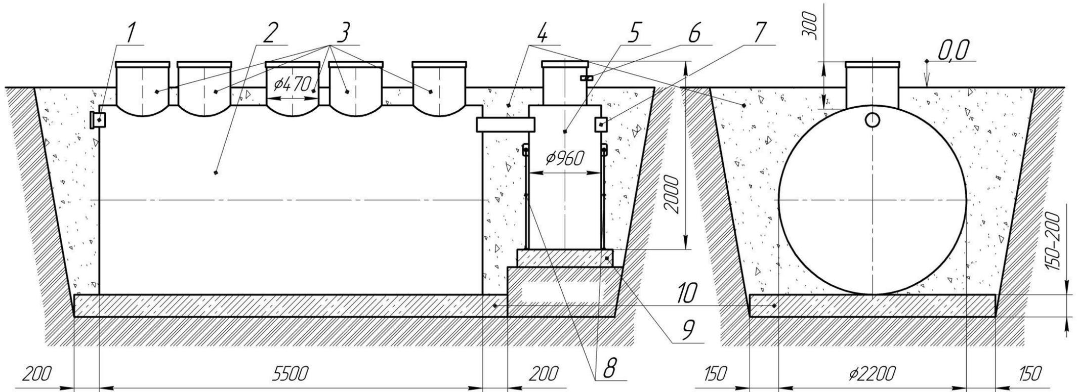
1 – Патрубок входной; 2 – Корпус ЛОС «Биосфера 50»; 3 – Горловины; 4 – Песок уплотненный; 5 – Корпус установки УФО; 6 – патрубок выходной напорный; 7 – Патрубок аварийного слива; 8 – Стропы якорения корпуса УФ установки; 9 – железобетонное основание под УФО; 10 – железобетонное основание под ЛОС
