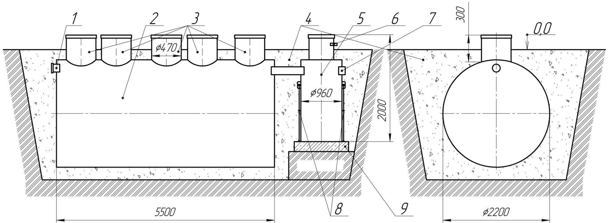
1 – Патрубок входной; 2 – Корпус ЛОС «Биосфера 50»; 3 – Горловины; 4 – Песок уплотненный; 5 – Корпус установки УФО; 6 – патрубок выходной напорный; 7 – Патрубок аварийного слива; 8 – Стропы якорения корпуса УФ установки; 9 – железобетонное основание
